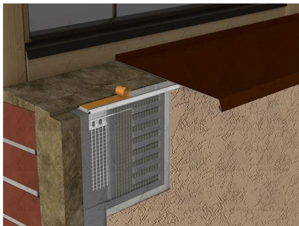
**Применение:** Монтажный профиль для подоконников используется как расширяющее соединение между подоконником и штукатуркой. Соединение профиля со стекловолоконной сеткой используется для изоляции.
